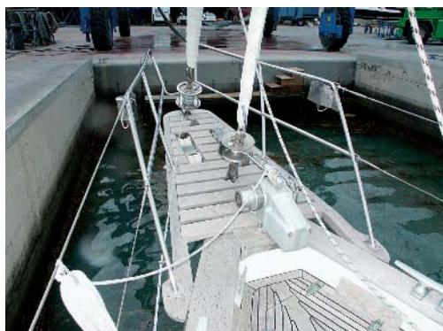
Particolare della delfiniera con gli avvolgifiocco e il salpancora. Il tunnel integrale dell'asse dell'elica. Il momento del varo, si noti la pinna di zavorra oceanica, molto estesa longitudinalmente.
